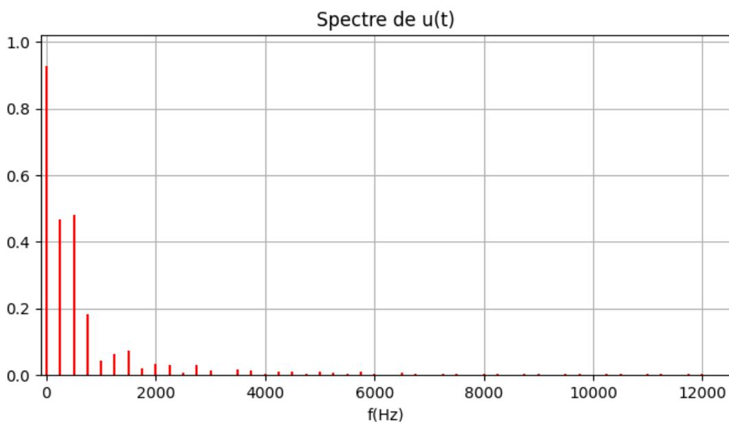
FIGURE 8 – Le spectre de la fonction  $u(t)$  de la Figure 7.
