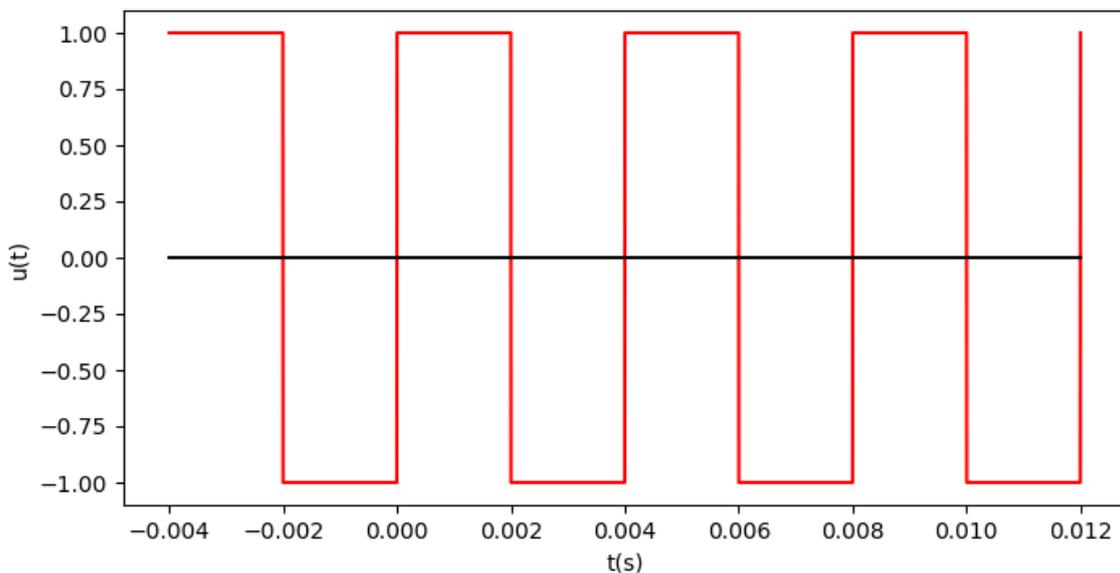
FIGURE 1 – Une fonction  $u(t)$  créneau d’amplitude 1 et de fréquence  $f_1 = 250$  Hz. Elle est représentée sur un intervalle de quatre périodes.
