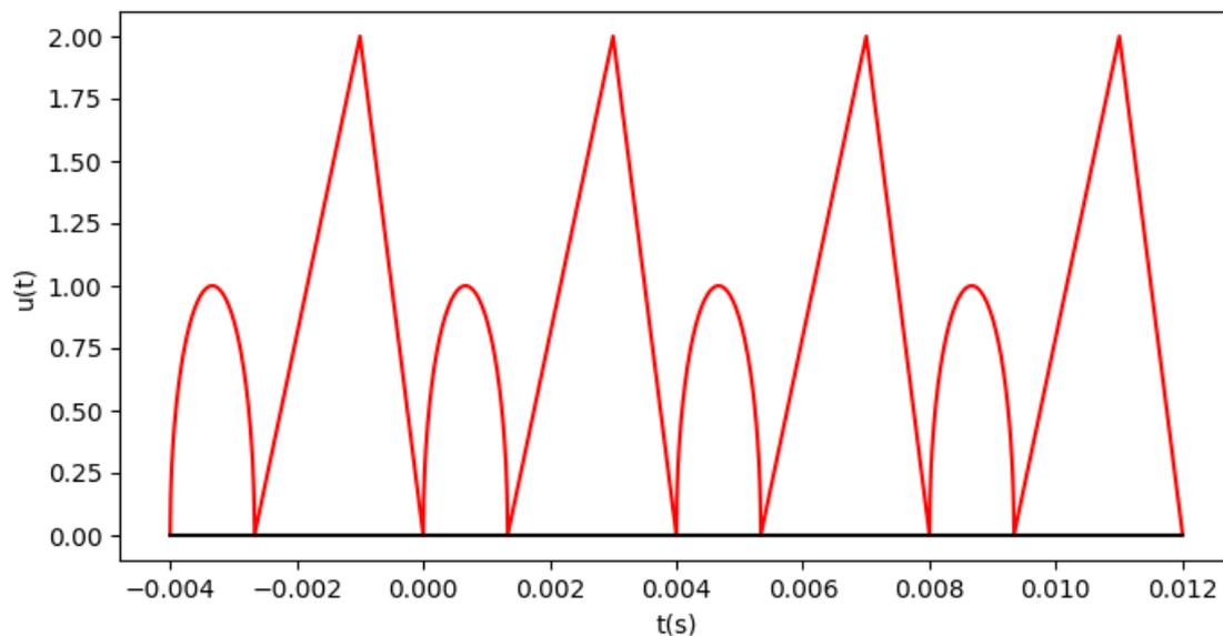
FIGURE 7 – Une fonction  $u(t)$  périodique de fréquence  $f_1 = 250$  Hz, représentée sur quatre périodes.
