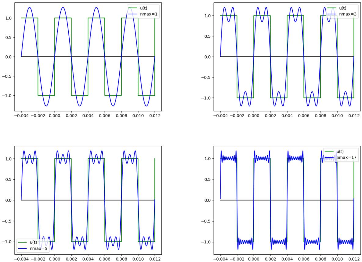
FIGURE 3 – Quatre sommes partielles pour la fonction créneau de la Figure 1. Dans chaque cas, la somme partielle est superposée à la fonction  $u(t)$ .
