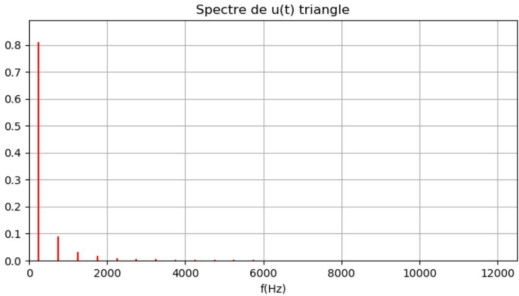
FIGURE 5 – Le spectre de la fonction  $u(t)$  en triangle de la Figure 4.
