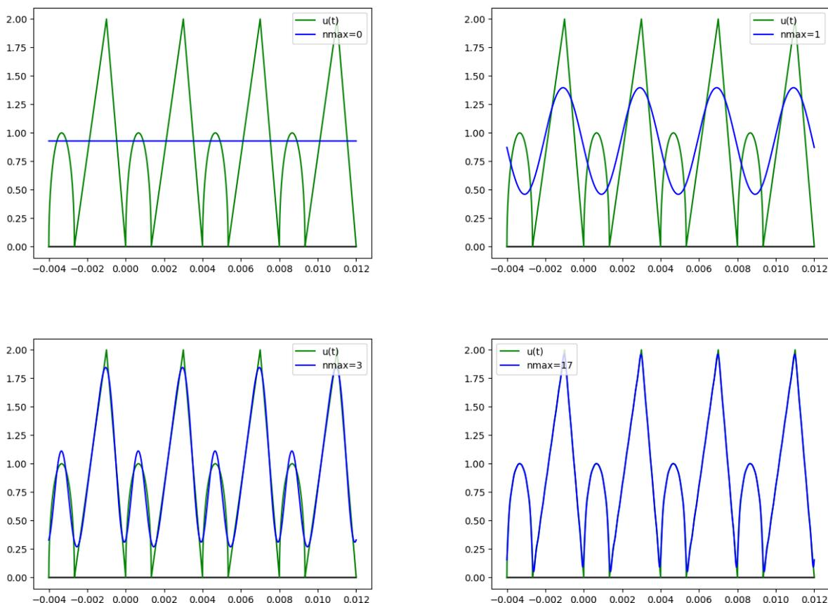
FIGURE 9 – Quatre sommes partielles pour la fonction  $u(t)$  de la Figure 7. Dans chaque cas, la somme partielle est superposée à la fonction  $u(t)$ . On remarquera en particulier le cas  $nmax = 0$  : pour approximer du mieux possible la fonction  $u(t)$  par une fonction constante, il convient de prendre pour cette constante la valeur moyenne de  $u(t)$ . On se reportera éventuellement à la version en couleurs sur <https://physique.colin-andre.fr/>.
